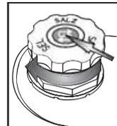
Vissez le bouchon. Eliminez les résidus de sel autour du bouchon. Certains réservoirs à sel ont un indicateur de niveau intégré dans le bouchon (voir comment contrôler ci-dessous).
