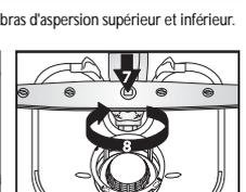
Insérez et serrez à fond les bras d'aspersion supérieur et inférieur.
