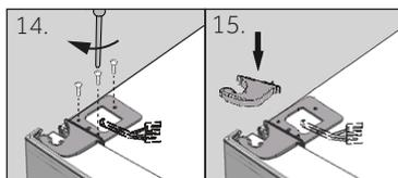
14. Retirez la charnière supérieure du sac contenant les accessoires. Passez le câble de raccordement dans la charnière supérieure et fixez-la à l'aide des trois vis situées sur le côté gauche de l'appareil.
