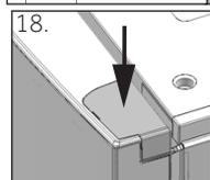
18. Sortez la nouvelle charnière du sac contenant les accessoires et fixez-la sur le côté gauche de la porte supérieure.
