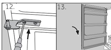
12. Sortez la nouvelle charnière supérieure de la porte supérieure du sac contenant les accessoires et vissez-la sur le côté gauche de l'appareil.
