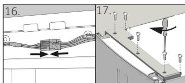
16. Connectez le câble de raccordement et fixez-le dans l'ouverture.
